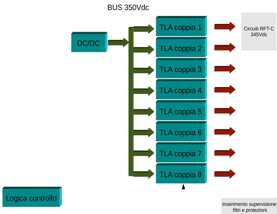
Ogni scheda **TA 181.8** è costituita da un convertitore di tensione 48/359V e 8 sistemi di controllo indipendenti, ognuno in grado di erogare una tensione compresa tra 340 e 350 Volts in continua con una corrente massima di 60 mA.
